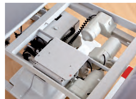
De fyra motorerna är placerade direkt under det avtagbara sätet för enkel service.
